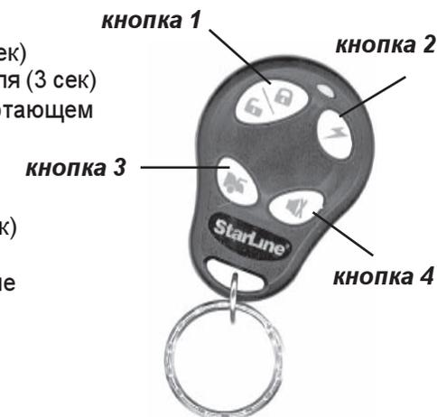
В четырехкнопочном брелке без обратной связи используется литиевый элемент питания CR2032, 3В. Время работы одного элемента питания зависит от частоты пользования брелком и от типа установленного элемента.
