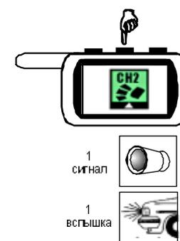
Дополнительный канал №2 (желто-красный провод) может быть активизирован независимо от состояния режима охраны на 0,8, 10, 30 секунд или до выключения брелком. Длительность выходного сигнала программируется при установке системы (функция 4). Канал может быть использован для дистанционного управления дополнительным оборудованием автомобиля.
