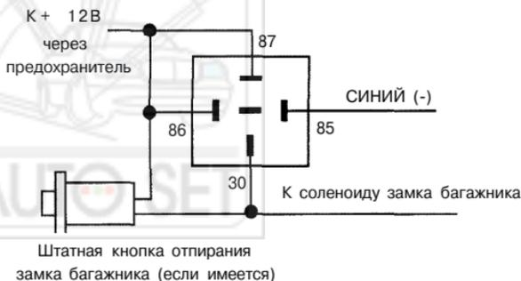
**ПОДСОЕДИНЕНИЕ ДОПОЛНИТЕЛЬНОГО Н.З. РЕЛЕ
