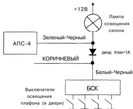
3. Рекомендуемая схема подключения ТЕМНО-ЗЕЛЕНОГО провода системы ("отрицательный триггер капота/багажника") к подкапотной лампе автомобилей ВАЗ семейств 2109, 2115, 2123 или лампе освещения багажника автомобилей ВАЗ семейства 2115:
