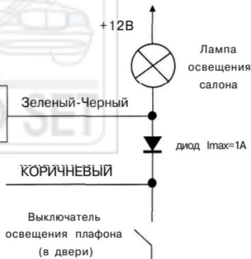
2. Рекомендуемая схема подключения КОРИЧНЕВОГО провода системы ("отрицательный триггер двери") к проводке автомобилей ВАЗ семейств 2110 и 2115, оснащенных иммобилайзерами АПС-4:
