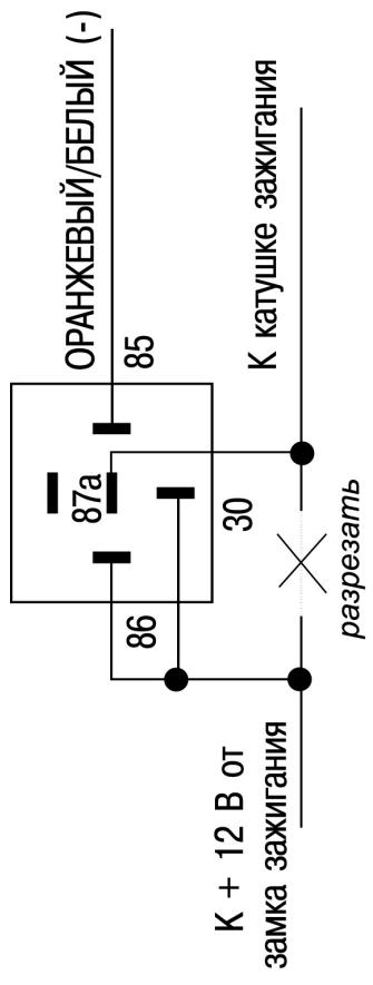
ПРИМЕЧАНИЕ: Данная схема может также использоваться для подключения СИНЕГО провода (см. программирование функции # 11)
